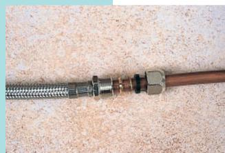
**3. De l'autre côté, un raccord rapide à rondelle conique assure l'assemblage avec la canalisation d'arrivée d'eau en cuivre.**
